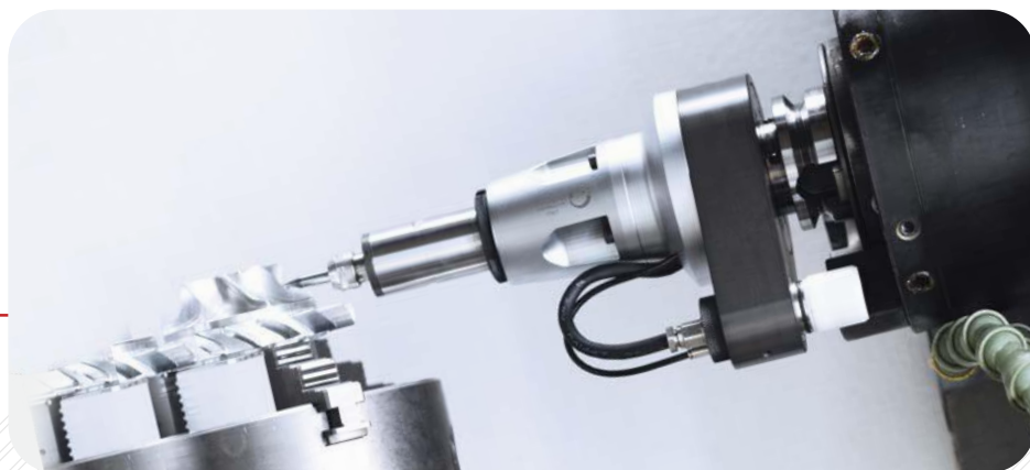
MOLTIPLICATORE ELETTRICO ELECTROSPINDLE Max 80.000 RPM
